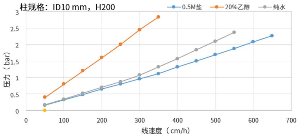
图 3. Proteomix POR45-HQ 压力流速曲线图
